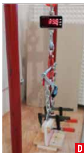
Spezialgipsplatte Flamtex T-förmig verklebt => Abriss der Decklage der Gipsplatte bei 79,5 kg
