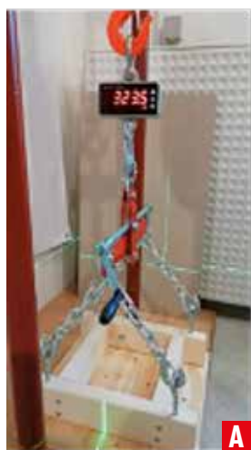
Hartgipsplatte verklebt auf Holz-Mehrschichtplatte => Ausbruch der Verschraubungen aus der Gipskartonplatte bei 323,5 kg
