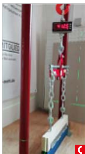
UW 50-Profil verklebt auf Rechteck-Stahlhohlprofil => Bruch der Verklebung bei 412,5 kg
