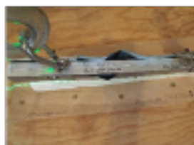
Deckenprofil verklebt auf Holz-Mehrschichtplatte => Deformation des Profils bewirkt Abschälung bei 307,5 kg
