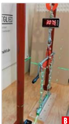
Deckenprofil verklebt auf Holz-Mehrschichtplatte => Deformation des Profils bewirkt Abschälung bei 307,5 kg
